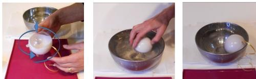
**NB:** Pour une prise plus rapide vous pouvez roto-mouler sous le robinet et mettre ensuite votre moule dans l'eau froide ou au réfrigérateur.
